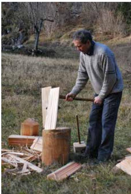
Fig. 12. Realizzazione di scandole da parte di un operaio dell'Ente Parco.
