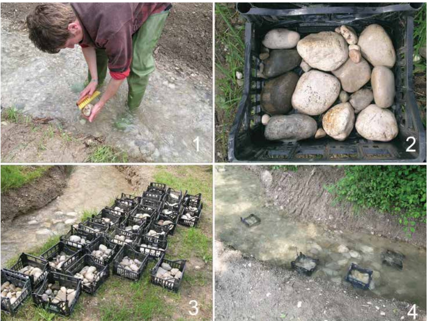
Fig. 7. Fasi della preparazione dei substrati artificiali: 1. Raschiatura dei ciottoli; 2. Substrato artificiale composto di ciottoli e ghiaia grossolana puliti; 3. Substrati pronti per l'inserimento in alveo; 4. Alcuni substrati posizionati in alveo ed assicurati mediante picchetti in ferro (tratto da DAL CORTIVO, 2008).
